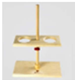
SUPORE PARA BUTIRÔMETRO
