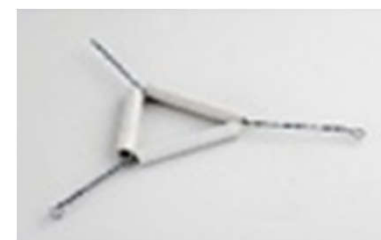
TRIÂNGULO DE ARAME GALVANIZADO COM TUBOS DE PORCELANA
