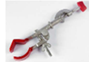
PINÇA PARA CONDENSADOR COM UMA GARRA OVAL E OUTRA EM PRISMA E MUFA
