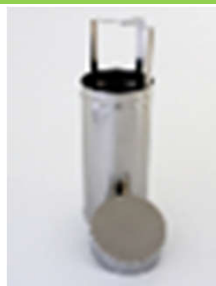
ESTOJO CILÍNDRICO PARA ESTERILIZAÇÃO DE PLACAS DE PETRI
