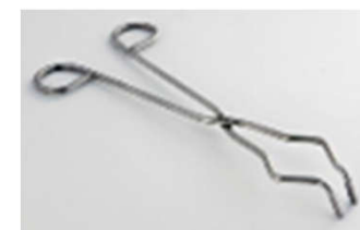
PINÇA TENAZ PARA CADINHO COM PONTA CURVA (L)
