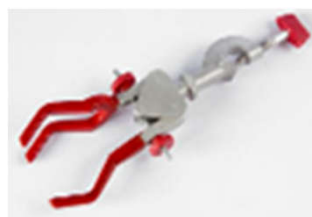
PINÇA PARA CONDENSADOR COM 3 DEDOS E MUFA
