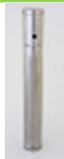
ESTOJO CILÍNDRICO PARA ESTERILIZAÇÃO DE PIPETAS
