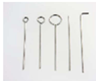
ALÇA DE NÍQUEL-CROMO PARA CABO DE KOLLE
